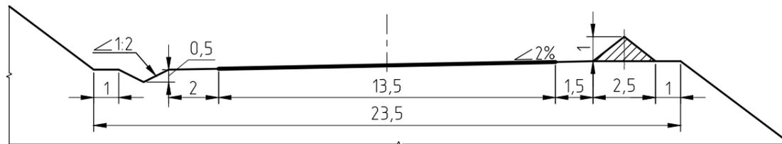
Конструкция постоянной однополосной автодороги
