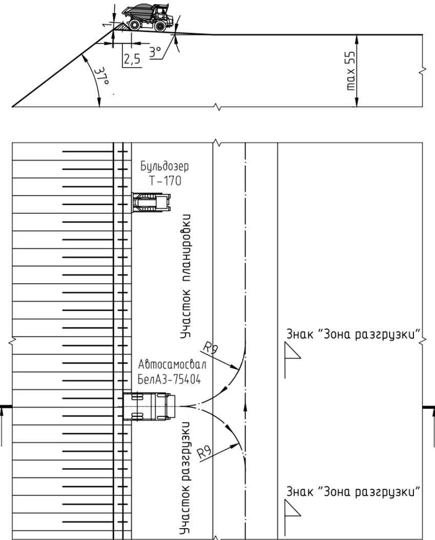
Конструкция постоянной двухполосной автодороги
