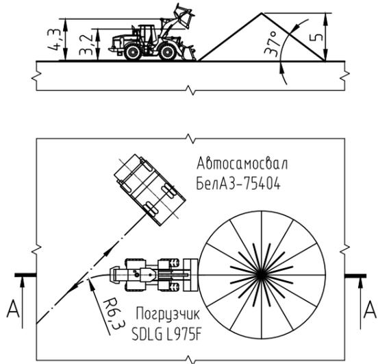
Схема бульдозерного отвалообразования
